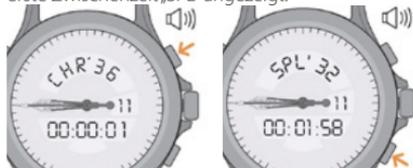
3. Durch ein zweites Mal Drücken auf den Drücker **B** wird die Zeitnahme fortgesetzt, wobei die verstrichene Zeit aufgeholt wird. Durch ein drittes Mal Drücken wird die zweite Zwischenzeit angezeigt. Gehen Sie für jede weitere Zwischenzeit gleich vor.
