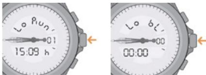
3. 将表冠拉出至位置 (p2)。显示指示 “CLEAR” 和轮挡计时号。
