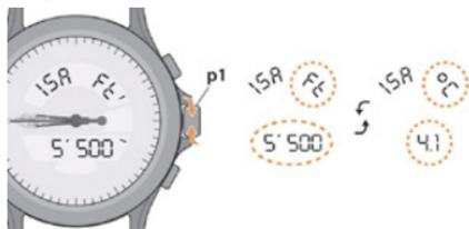
2. Une pression courte sur le poussoir **A** ou **B** permet d'augmenter ou de réduire l'altitude par palier de 500 pieds ou 150 mètres.
