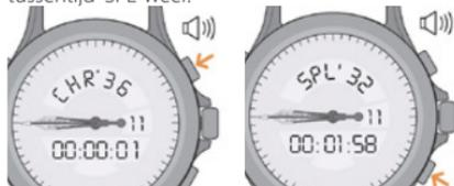
3. Een tweede druk op drukknop **B** laat de meting doorgaan en de verloren tijd wordt ingehaald. Een derde druk geeft de tweede tussenliggende tijd weer. Ga op dezelfde wijze door voor alle andere tussenliggende tijden.
