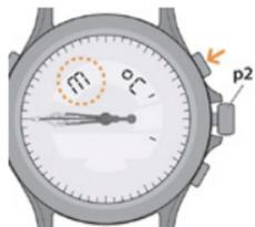
3. Una breve pressione del pulsante **B** modifica l'unità di misura della temperatura.
