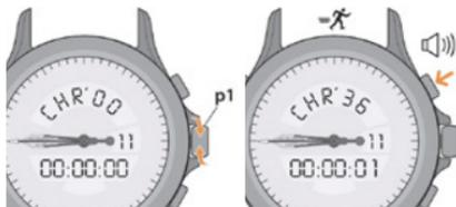
3. Una breve pressione del pulsante **A** arresta il cronografo e il display indica il risultato con "Add" seguito dai centesimi di secondo e, sotto, ore, minuti e secondi. Una seconda pressione del pulsante riavvia la misura aggiungendo i tempi.
