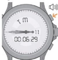
4. Al termine del conto alla rovescia, il display "TM" lampeggia e la suoneria si attiva per una ventina di secondi.
