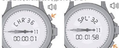
3. Με ένα δεύτερο πάτημα του κουμπιού **B**, η μέτρηση συνεχίζεται και ανακτάει ο χρόνος που έχει παρέλθει. Με ένα τρίτο πάτημα, εμφανίζεται ο δεύτερος ενδιάμεσος χρόνος. Συνεχίστε με τον ίδιο τρόπο, για όλους τους υπόλοιπους ενδιάμεσους χρόνους.
