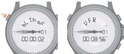
2. Με ένα στιγμιαίο πάτημα του κουμπιού
