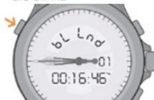
2. Durch ein kurzes Drücken auf den Drücker B wird kurz die Anzahl der Flugzyklen angezeigt, danach erscheint wieder die Anzeige „bl Lnd“. Da in unserem Beispiel die erste Landung erfolgt ist, wird für die Anzahl der Flugzyklen „01“ angezeigt.
