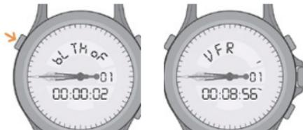
2. Al presionar brevemente el pulsador **A**, se cambiará del modo «VFR» al modo «IFR» y a la inversa.
