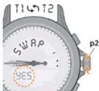
6. Voltar a empurrar a coroa para a posição (p1); ocorre a troca dos fusos horários «T1» e «T2» e os ponteiros assumem a posição do novo fuso horário «T1».
