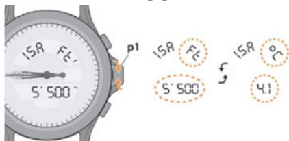
2. Met een korte druk op drukknop **A** of **B** kan de hoogte in stappen van 500 voet of 150 meter verhoogd of verlaagd worden.
