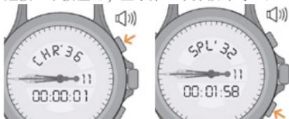
3. 再按一下按钮 B，定时继续进行，并接上已过的时间。第三次按下则显示第二段计时。如需增加计时段，则重复以上相同步骤。
