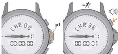
3. 短按一下按钮 B 停止计时器，显示器指示结果，并在“Add”后方显示百分秒、小时、分钟和秒。再按一次按钮将再次启动定时，计时结果与前一次计时结果相加。
