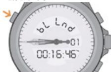
2. プッシュボタン **(B)** を短く押すと、サイクル数が短く表示され、その後、「bL Lnd」の表示に戻ります。この例では、最初の着陸が実施されており、表示されるサイクル数は 01 です。
