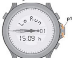
2. Chaque pression courte sur le poussoir A ou B permet de sélectionner et faire défiler dans un sens ascendant ou descendant, les enregistrements de chaque bloc et du total «to».
