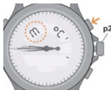
3. Durch ein kurzes Drücken auf den Drücker B wird die Maßeinheit für die Temperatur geändert.
