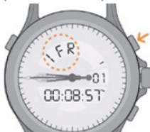
3. Одно краткое нажатие кнопки **B** ненадолго выводит на дисплей число циклов, а затем дисплей возвращается к индикации режима «VFR» или «IFR». В нашем примере еще не было посадки, поэтому число циклов на дисплее 00.
