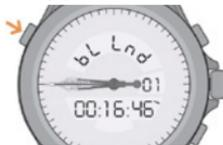
2. Одно краткое нажатие кнопки **B** ненадолго выводит на дисплей число циклов, а затем дисплей возвращается к индикации «bL Lnd».
