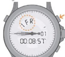
3. Durch ein kurzes Drücken auf den Drücker B wird kurz die Anzahl Flugzyklen angezeigt, danach erscheint wieder die „VFR“- bzw. „IFR“-Anzeige. Da in unserem Beispiel noch keine Landung erfolgt ist, wird für die Anzahl der Flugzyklen „00“ angezeigt.
