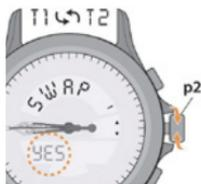
6. リューズを位置 (p1) に押し戻すと時間帯「T1」と「T2」が切り替わり、針は第1時間帯「T1」の時刻を表示するようになります。
