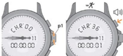
3. Uma pressão breve no botão **A** pára o cronógrafo e o resultado é indicado através de um «Add'» seguido dos centésimos de segundo e, por baixo, as horas, os minutos e os segundos. Uma segunda pressão no botão retoma a medição, adicionando tempos.
