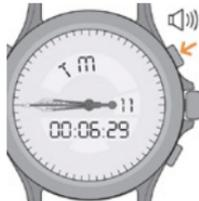
4. Aan het eind van het terugtellen knippert de weergave "TM" en klinkt een geluid gedurende ongeveer twintig secondes.
