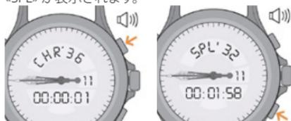
3. もう一度プッシュボタン **B** を押すと、計測が続行され、針は経過時間に追いつきます。さらにもう一度プッシュボタン **B** を押すと、2 番目の経過時間が表示されます。同じ操作を繰り返して複数回の経過時間の計測が行えます。
