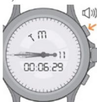
4. После завершения обратного отсчета на дисплее начинает мигать «ТМ» и в течении двадцати секунд раздается звуковой сигнал.
