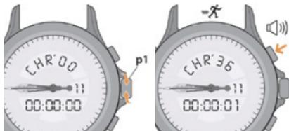
3. Une pression courte sur le poussoir **A** arrête le chrono et l'affichage indique le résultat par un «Add» suivi des centièmes de secondes et en dessous les heures, minutes et secondes. Une deuxième pression sur le poussoir relance la mesure en additionnant les temps.
