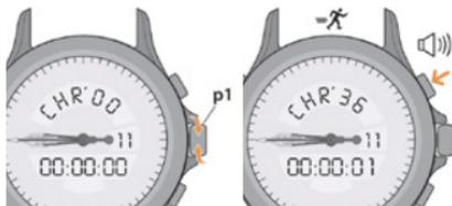
3. Een korte druk op de drukknop **A** stopt de chronograaf en de weergave geeft het resultaat weer met een "Add" gevolgd door honderdsten van secondes en eronder de uren, minuten en secondes. Door een tweede druk op de drukknop start de meting door het optellen van de tijden.
