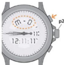
5. Vuelva a presionar la corona en la posición (p1) para confirmar los ajustes.
