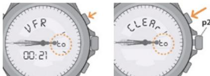
5. 將錶冠壓回位置 (p1) 回到原始畫面。各次飛行紀錄的編號將向前移。若全部消除，則畫面會完全歸零。
