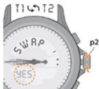
6. Vuelva a presionar la corona hasta la posición (p1); los husos horarios «T1» y «T2» se permutarán y las agujas se colocarán en la posición del nuevo huso horario «T1».
