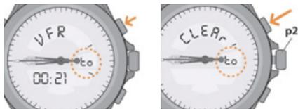
5. Voltar a empurrar a coroa para a posição (p1), para regressar à indicação de base. Os números de cada voo restante são escalonados. Em caso de eliminação total, a indicação é totalmente reposta a zero.
