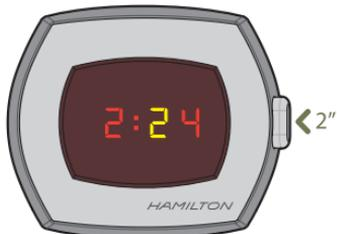
Après le réglage des heures, appuyez 2 secondes sur le poussoir pour passer au réglage des dizaines de minutes.
