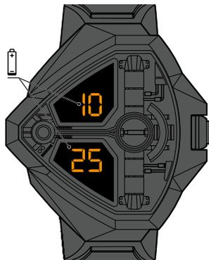
**Note:** In queste due situazioni non è più possibile illuminare l'ora, al fine di conservare la poca energia residua della batteria. L'orologio continuerà invece a funzionare correttamente e sarà possibile eseguire le regolazioni.
