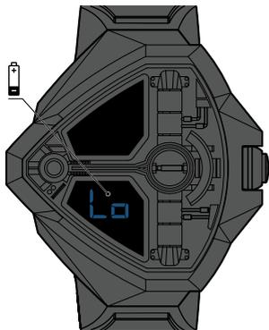
Quando la batteria arriva a fine vita, viene visualizzato per 1 secondo "Lo" che si alterna con la visualizzazione dell'ora, che dura 9 secondi. Questo significa che è ora di sostituire la batteria.
