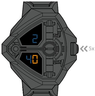
Mit jedem Betätigen des Drückers wird die Anzeige um eine Einheit höher geschaltet.
